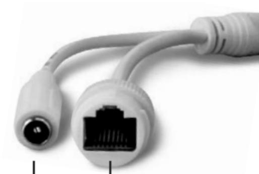
12 V DC Betriebsspannung    Netzwerk
